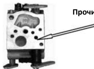
**ВАЖНО:** Топливная заслонка карбюратора должна периодически протираться. Осторожно снимите кожух помпы (на внутренней стороне карбюратора), прокладку и мембрану помпы. Заслонка станет видна.
